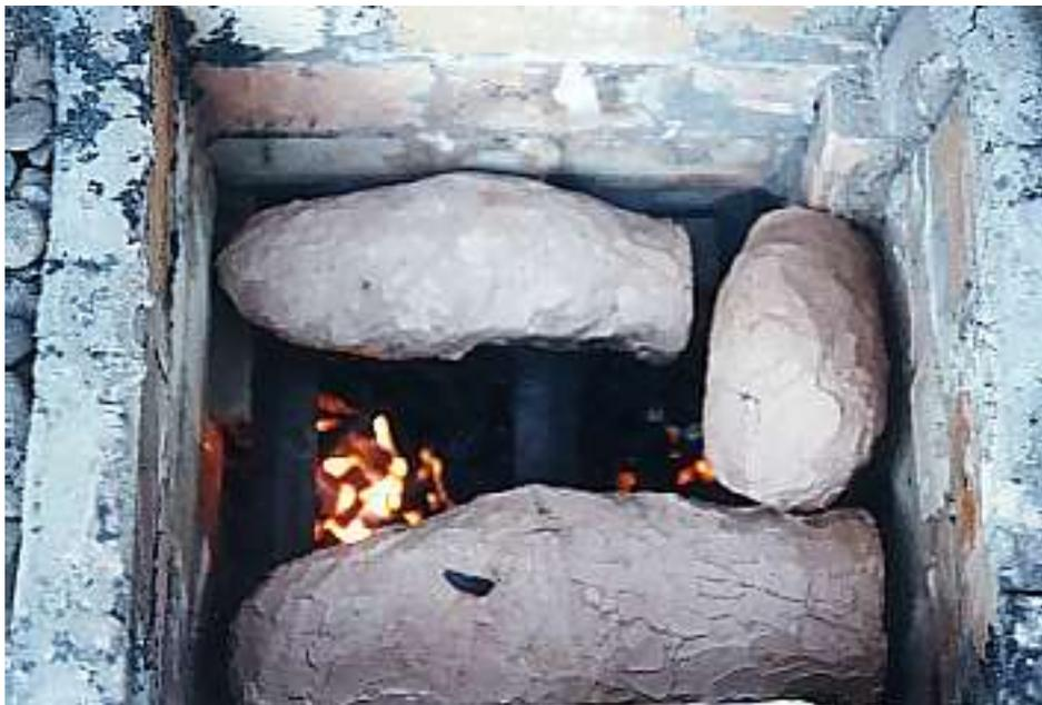
3. Eine alte Giesserfaustregel sagt: Kommt kein Rauch mehr aus dem Eingusstrichter der Gussform, so ist sie vollständig ausgeglüht. Dieser Ausspruch ist nicht wirklich richtig.
