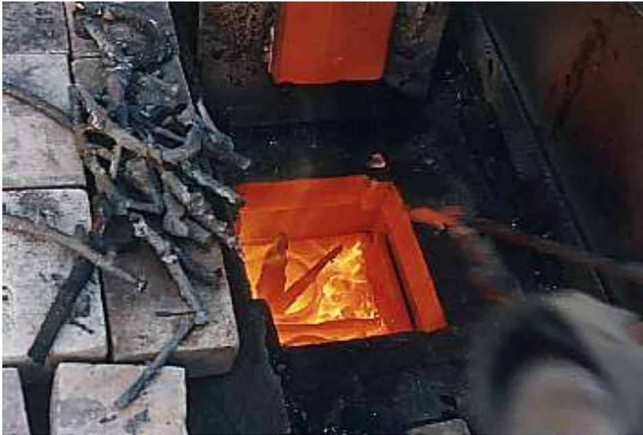
**2. Der Tiegel darf keine Risse aufweisen. Den Tiegel vor dem Einfüllen des Metalls immer vorheizen. Wenn der Tiegel ein helles Kirschrot aufweist, ist er für die Aufnahme des Metalls bereit. Das Aufheizen eines 9 Liter Tiegels dauerte in diesem Fall ca. 25 Min.. Das Metall stets mit einer Zange in den Tiegel legen und nicht hineinwerfen. Kalte Metallstücke immer auf dem Deckel des Ofens vorwärmen. Stark verschmutztes Metall vor dem Aufwärmen mit Wasser, Bürste und Seife reinigen.**
