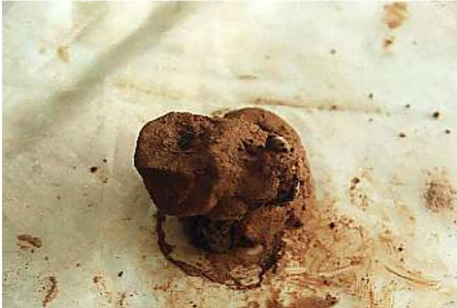
5. Darauf folgt der selbe Prozess wie beim Giessen einer ganzen Skulptur. Das Wachs wird ausgeschmolzen. Das Ausglühen muss man so vornehmen, dass der intakte Teil der Skulptur nicht zu schmelzen beginnt. Dann wird die Bronze für den Fuss geschmolzen und in den Eingusstrichter geschüttet. Nun ist eine neuer Fuss fest mit der übrigen Skulptur verbunden. Mit dieser Ueberfangmethode (casting on) kann man viele Teile miteinander zusammengiessen.
