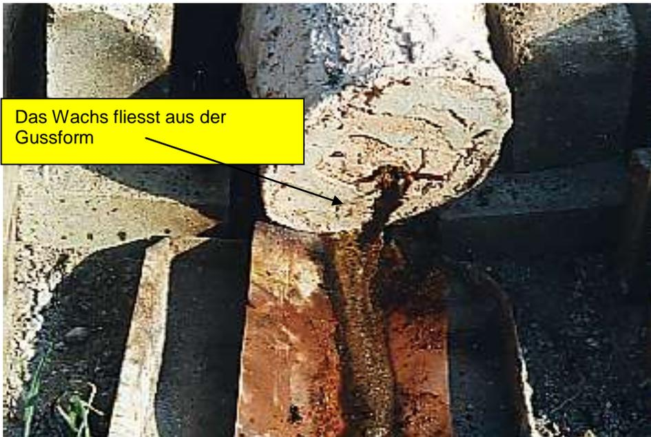
**3. Achtung! Das Wachs muss auf jeden Fall aus der Gussform entfernt worden sein!** Würde das Wachs in der Gussform bleiben, könnte dieses beim Ausglühen der Gussform explosionsartig verbrennen und dadurch die Gussform zerstören. Es ist klar, dass ein kleiner Teil Wachs nach dem Ausschmelzen immer noch in der Gussform vorhanden ist; dieser wird später beim Ausglühen vollständig verdampfen. **Lassen sie die Feuerstelle während des Ausschmelzens nie unbeaufsichtigt!**
