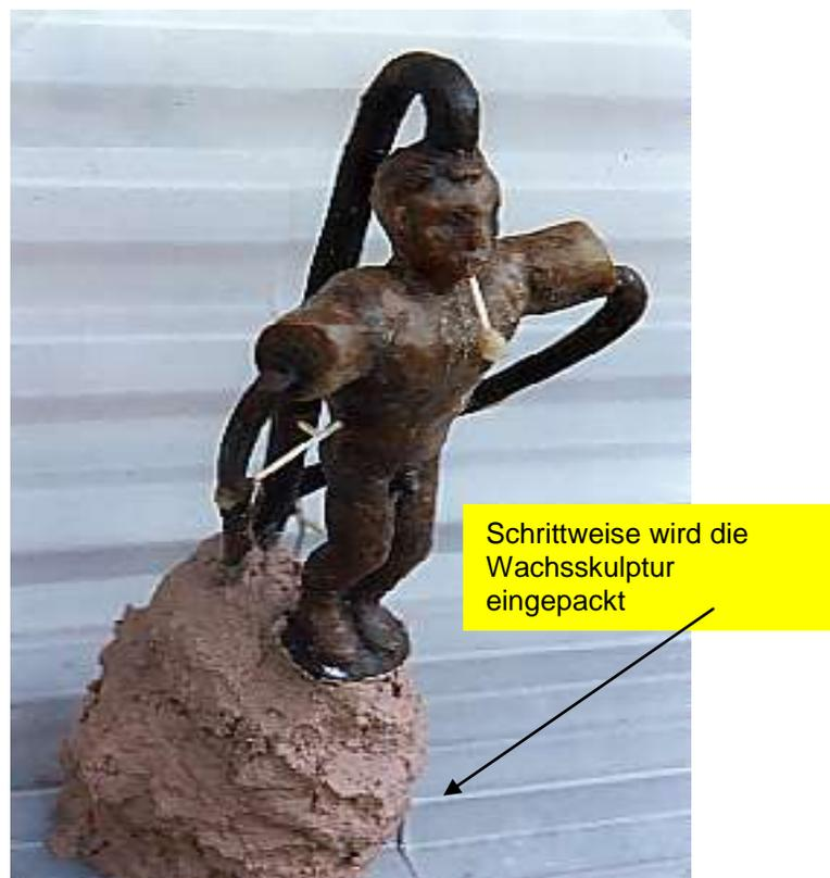
**Der Eingusstrichter und der Entlüftungskanal dürfen an ihren oberen Enden nie zugedeckt werden.** Denn beim einen giesst man das Metall hinein und beim anderen soll die Luft entweichen können. Eine 20 cm hohe
